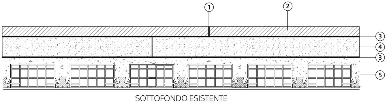
1. **Mapelastic (Mapei)** Malta cementizia liquida da posare nei giunti di dilatazione di spessore 3 mm e nei bordi perimetrali.
