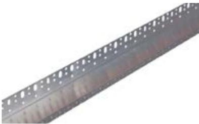
Profilo indeformabile in alluminio di spessore compreso tra 0,8 e 1,2 mm con gocciolatoio. Utilizzato per la corretta tenuta inferiore del sistema d'isolamento a cappotto. La particolare foratura laterale del profilo ne permette un veloce ancoraggio al supporto. Se ne consiglia l'impiego assieme al profilo DRIP STARTER PVC, per una maggiore protezione dall'umidità.
