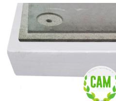
Pannello in polistirene densità 15÷35 kg/m<sup>3</sup> | Conduttività termica dichiarata  $\lambda_D$ [W/(m\*k)] 0,026÷0,036 | Calore specifico c 1.200 J/kg K
