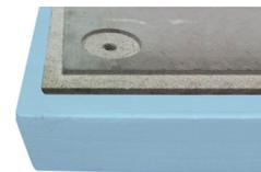
Pannello in polistirene densità 15÷35 kg/m<sup>3</sup> | Conduttività termica dichiarata  $\lambda_b$ [W/(m\*k)] 0,026÷0,036 | Calore specifico c 1.450 J/kg K
