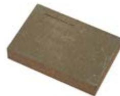
Pannello in cementolegno densità 1350 kg/m<sup>3</sup> | Conduttività termica dichiarata  $\lambda_p$ [W/(mk)] 0,26 | Calore specifico c 1.880 J/kg K
