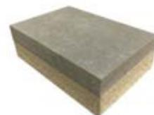
Cementolegno densità 1350 kg/m<sup>3</sup> | Conduttività termica dichiarata  $\lambda_D$ [W/(mk)] 0,26 | Calore specifico c 1.880 J/kg K
