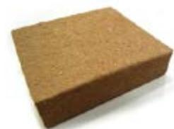
Pannello in fibra di legno densità 250 kg/m<sup>3</sup> | Conduttività termica dichiarata  $\lambda_D$ [W/(mk)] 0,048 | Calore specifico c 2.100 J/kg K
