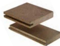
Pannello in cementolegno densità 1350 kg/m<sup>3</sup> | Conduttività termica dichiarata  $\lambda_p$ [W/(mk)] 0,26 | Calore specifico c 1.880 J/kg K
