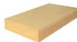
Pannello in fibra di legno densità 110 kg/m<sup>3</sup> | Conducibilità termica dichiarata  $\lambda_D$ [W/(mk)] 0,037 | Calore specifico c 2.100 J/kg K
