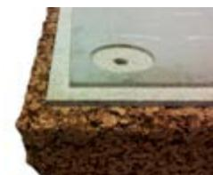
Cementolegno densità 1350 kg/m<sup>3</sup> | Conduttività termica dichiarata  $\lambda_D$  [W/(mk)] 0,26 | Calore specifico c 1.880 J/kg K
