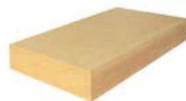
Pannello in fibra di legno densità 140 kg/m<sup>3</sup> | Conduttività termica dichiarata  $\lambda_D$  [W/(mk)] 0,040 | Calore specifico c 2.100 J/kg K
