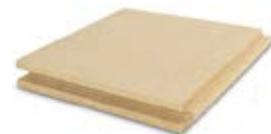
Pannello in fibra di legno densità 180 kg/m<sup>3</sup> (60+100) | Conduttività termica dichiarata  $\lambda_D$  [W/(mk)] 0,043 (60+100) | Calore specifico c 2.100 J/kg K
