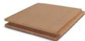
Pannello in fibra di legno densità 270 kg/m<sup>3</sup> | Conduttività termica dichiarata  $\lambda_D$  [W/(mk)] 0,048 | Calore specifico c 2.100 J/kg K
