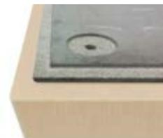
Cementolegno densità 1350 kg/m<sup>3</sup> | Conduttività termica dichiarata  $\lambda_p$  [W/(mk)] 0,26 | Calore specifico c 1.880 J/kg K
