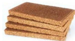
Pannello in sughero compresso densità 150+160 kg/m<sup>3</sup> | Conduttività termica dichiarata λ<sub>D</sub>[W/(mk)] 0,041 | Calore specifico c 1.674 J/kg K
