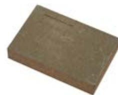
Pannello in cementolegno densità 1350 kg/m<sup>3</sup> | Conduttività termica dichiarata  $\lambda_D$ [W/(mk)] 0,26 | Calore specifico c 1.880 J/kg K
