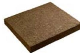
Pannello in fibra di legno bitumata densità 280 kg/m<sup>3</sup> | Conduttività termica dichiarata  $\lambda_D$  [W/(mk)] 0,050 | Calore specifico c 2.100 J/kg K
