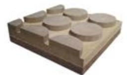
Cementolegno densità 1350 kg/m<sup>3</sup> | Conduttività termica dichiarata  $\lambda_D$ [W/(mk)] 0,26 | Calore specifico c 1.880 J/kg K
