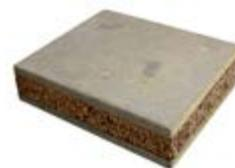
Cementolegno densità 1350 kg/m<sup>3</sup> | Conduttività termica dichiarata  $\lambda_D$ [W/(mk)] 0,26 | Calore specifico c 1.880 J/kg K
