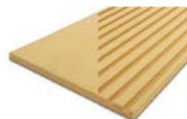
Pannello in fibra di legno densità 140 kg/m<sup>3</sup> | Conduttività termica dichiarata  $\lambda_D$  [W/(mk)] 0,040 | Calore specifico c 2.100 J/kg K
