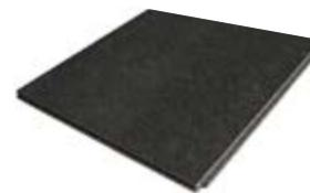
Pannello in fibra di legno bitumata densità 260 kg/m<sup>3</sup> | Conduttività termica dichiarata  $\lambda_D$  [W/(mk)] 0,050 | Calore specifico c 2.100 J/kg K
