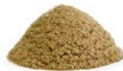
Fibra di legno sfusa densità 32 - 45 kg/m<sup>3</sup> in base all'applicazione | Conduttività termica dichiarata  $\lambda_b$ [W/(mk)] 0,038
