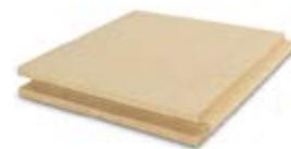
Pannello in fibra di legno densità 140 kg/m<sup>3</sup> | Conduttività termica dichiarata  $\lambda_D$  [W/(mk)] 0,040 | Calore specifico c 2.100 J/kg K
