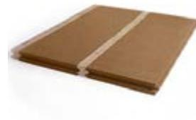
Pannello in fibra di legno densità 160 kg/m<sup>3</sup> | Conduttività termica dichiarata  $\lambda_D$  [W/(mk)] 0,038 | Calore specifico c 2.100 J/kg K
