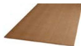
Pannello in fibra di legno densità 230 kg/m<sup>3</sup> | Conduttività termica dichiarata  $\lambda_D$ [W/(mk)] 0,050 | Calore specifico c 2.100 J/kg K
