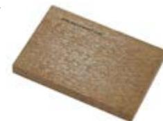
Pannello in cemento legno densità 1350 kg/m<sup>3</sup> | Conduttività termica dichiarata  $\lambda_p$ [W/(mk)] 0,26 | Calore specifico c 1.880 J/kg K
