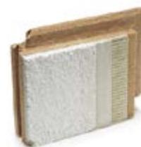
Pannello in fibra di legno densità 160 kg/m<sup>3</sup> | Conduttività termica dichiarata λ<sub>D</sub>[W/(mk)] 0,038 | Calore specifico c 2.100 J/kg K
