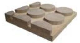
Cementolegno densità 1350 kg/m<sup>3</sup> | Conduttività termica dichiarata  $\lambda_D$ [W/(mk)] 0,26 | Calore specifico c 1.880 J/kg K
