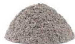
Fiocchi di cellulosa sfusi densità 27 - 60 kg/m<sup>3</sup> in base all'applicazione | Conduttività termica dichiarata  $\lambda_b$ [W/(mk)] 0,038
