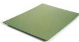
Pannello in fibra di legno densità 250 kg/m<sup>3</sup> | Conduttività termica dichiarata  $\lambda_D$ [W/(mk)] 0,070 | Calore specifico c 2.100 J/kg K
