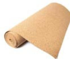
Rotolo in sughero supercompresso densità 150+160 kg/m<sup>3</sup> | Conduttività termica dichiarata  $\lambda_b$ [W/(mk)] 0,041 | Calore specifico c 1.674 J/kg K
