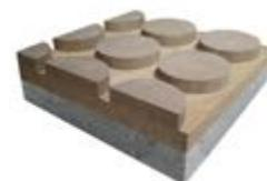
Cementolegno densità 1350 kg/m<sup>3</sup> | Conduttività termica dichiarata  $\lambda_D$ [W/(mk)] 0,26 | Calore specifico c 1.880 J/kg K
