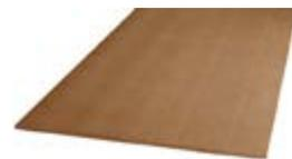
Pannello in fibra di legno densità 230 kg/m<sup>3</sup> | Conduttività termica dichiarata  $\lambda_D$ [W/(mk)] 0,050 | Calore specifico c 2.100 J/kg K
