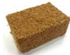
Pannello in fibra di legno densità 50 kg/m<sup>3</sup> | Conduttività termica dichiarata  $\lambda_p$ [W/(mk)] 0,038 | Calore specifico c 2.100 J/kg K
