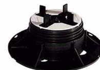
Il supporto **autolivellante** per pavimento è la scelta perfetta per la sopraelevazione: la testa in gomma anti rumore, la chiave di regolazione specifica, le altezze variabili, la base preincisa per taglio angolo muro. Possibilità di regolare millimetricamente l'altezza (regolabile da 25 a 270 mm), a favore di un perfetto livellamento della pavimentazione.
