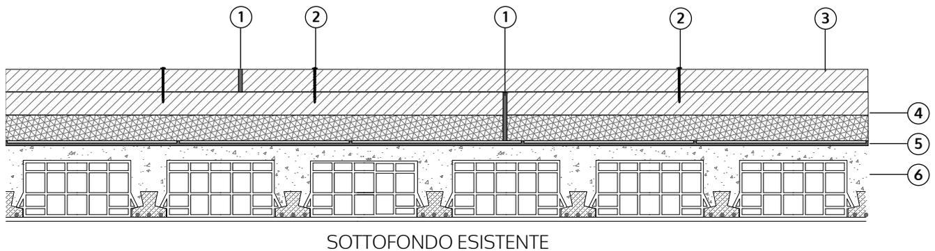
1. **Mapelastic (Mapei)** Malta cementizia liquida da posare nei giunti di dilatazione di spessore 3 mm e nei bordi perimetrali.
