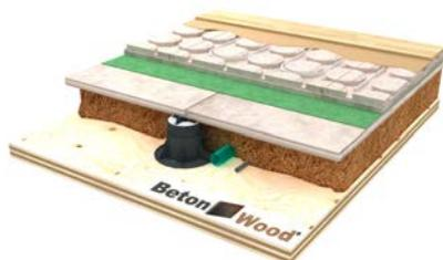
Sistema a secco completo per pavimenti galleggianti con pannelli radianti Betonradiant e cementilegno BetonWood con supporti regolabili su fibra di legno Zell
