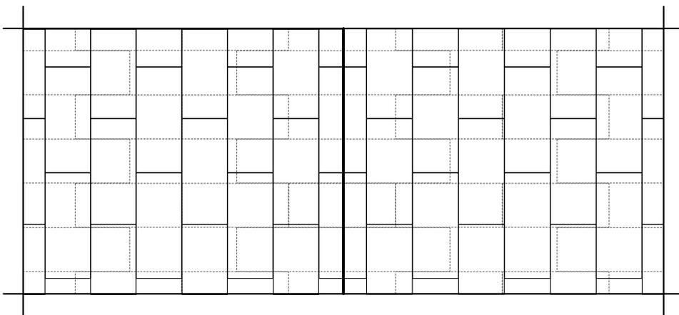
Disposizione sfalsata dei pannelli in cementolegno BetonWood<sup>®</sup> N rispetto ai pannelli accoppiati tipo Betonstyr XPS sottostanti e giunto di dilatazione al centro (necessario in stanze e ambienti che superano i 40m<sup>2</sup>).
