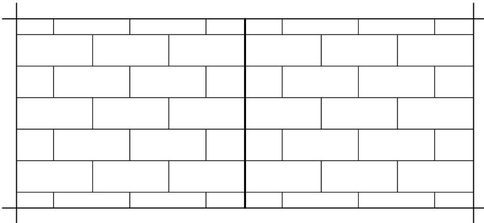
Disposizione sfalsata dei pannelli accoppiati tipo Betonstyr XPS sottostanti e giunto di dilatazione al centro (necessario in stanze e ambienti che superano i 40m<sup>2</sup>).
