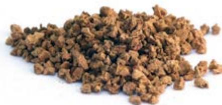
Il granulato in sughero biondo **CorkGranules**® è un isolamento termo-acustico per la realizzazione di massetti naturali e traspiranti. Utilizzato sia come sottopavimenti e sottotramezze per la formazione di pavimenti galleggianti, che come isolamento per intercapedine in sistemi isolanti a parete.
