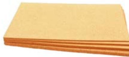
Il pannello in sughero biondo **CorkPanels plus**® è un isolamento termo-acustico naturale e traspirante per la realizzazione di massetti interni ed esterni. Ha una densità pari a 220 Kg/m<sup>3</sup>. Viene utilizzato anche in sistemi a pavimento sopraelevato e/o radiante.
