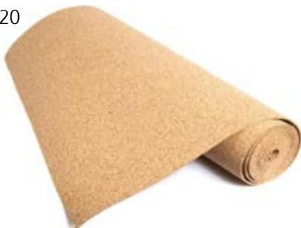
Il rotolo in sughero biondo **CorkRolls**® è un isolamento acustico per la realizzazione di massetti. Utilizzato nei sottopavimenti e sottotramezze per la formazione di pavimenti galleggianti. La densità di 150÷160 Kg/m<sup>3</sup> e l'elevata flessibilità evitano che il prodotto subisca schiacciamenti e ne consentono l'installazione su come spigoli, angoli e tubazioni.
